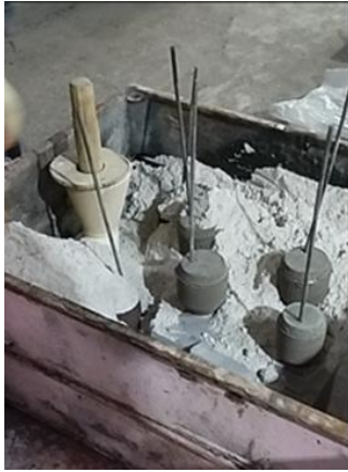
Diferentes fases del proceso de producción: moldeo, fundición y colada
